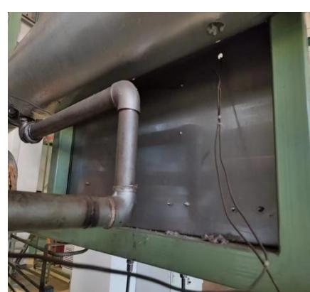
2、CP09\CP11 检测元器件检测线在穿过固定不锈钢板时没有进行保护；
