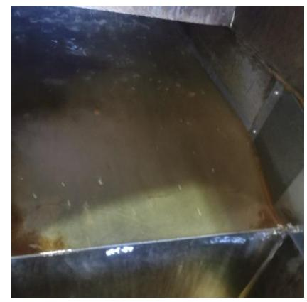
5、在上位机关闭工艺风门，当风门关闭后再停止升华系统，拖干净冷却振槽上清洗水。
