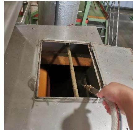
3、当清洗干净进料气锁后，手动关闭进料气锁按钮，在上位机处把升华系统切换至自动状态并开启，开启升华系统后手动开启工艺风机风门至 40%左右。
