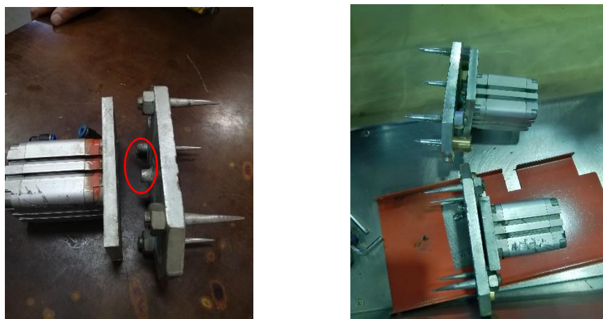
图 3 扎钉气动传动机构改进原理图
