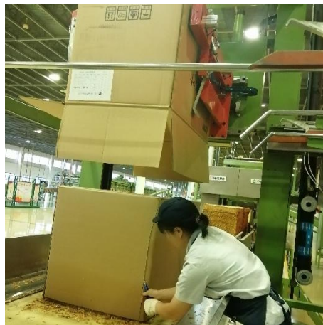
图1 生产现场内箱滑落故障
