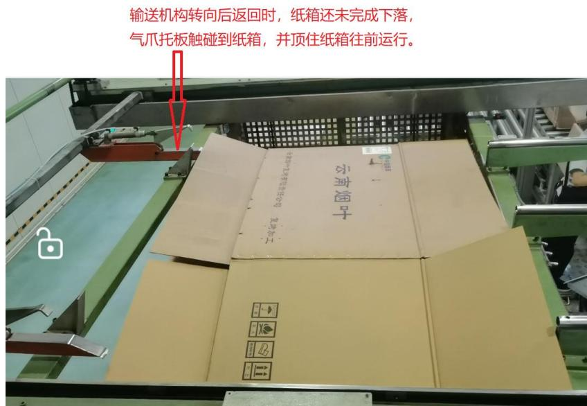
如上图所示，在生产过程中，经常出现纸箱脱箱后还未完全掉落在堆叠位，即纸箱还停留在气缸托板处，输送机构已转向返回运行而触碰到纸箱，输送机构的托板顶住纸箱运行导致码放失败，需人工手动操作进行干预完成纸箱码放，操作人员如处理不及时，则可能造成损坏设备、断料的后果。
