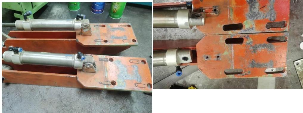
如上图所示，原气缸托板为安装孔结构，无调整位置，将安装孔改为安装槽结构，可以适当调整气缸托板的位置，将托板往后调整适当位置，既不影响取箱时气爪抓箱动作，又适当缩短气爪松开脱箱后纸箱在托板处的停留时间，降低脱箱机构转向返回时与纸箱干涉机率。
