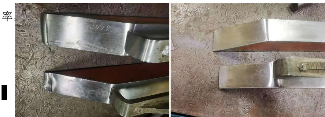
同时在生产过程中观察设备，发现取箱器托板前端插板处因长期工作并有碰撞情况已严重变形，如上图所示。脱箱时纸箱下落过程正
