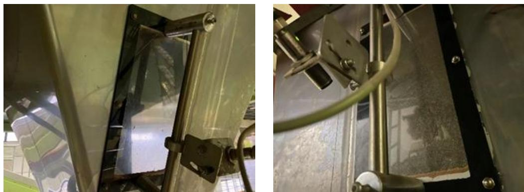
改进后：加装自动清吹装置后，岗位操作人员在生产前将压缩空气打开，可以实现对有机玻璃板的实时喷吹，杜绝物料、烟灰粘连，消除了高料位光电开关误判造成断料的情况。
