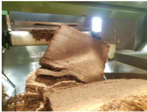
图 1 卸料侧倒烟片现场状况图
