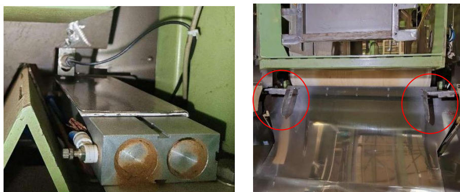
图 3 扶正机械臂装配效果图
