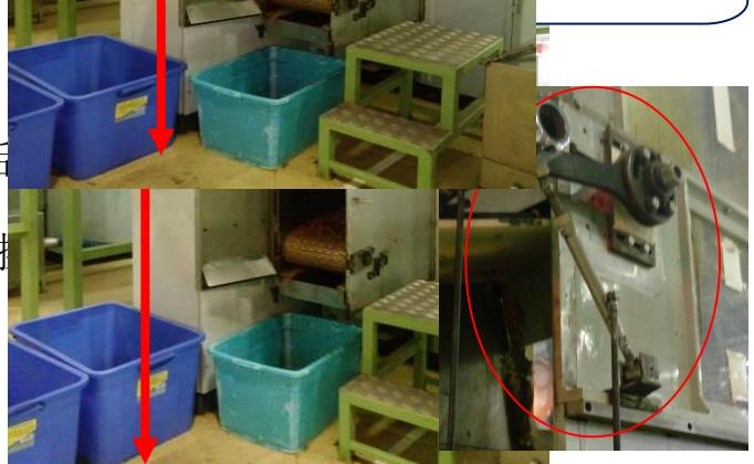
后推料板底部发生碰撞的安全隐患。
