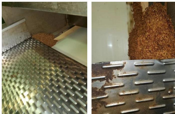
改进后：实地测量振槽槽体宽度和高速皮带宽度，测量高速皮带边缘至风选箱体间隙距离，计算导料板尺寸，制作并安装导料板，使物料由振槽输送至高速皮带上后，既不积留在高速皮带与箱体之间空间内，又不过于分布在高速皮带中间影响物料分布均匀性。
