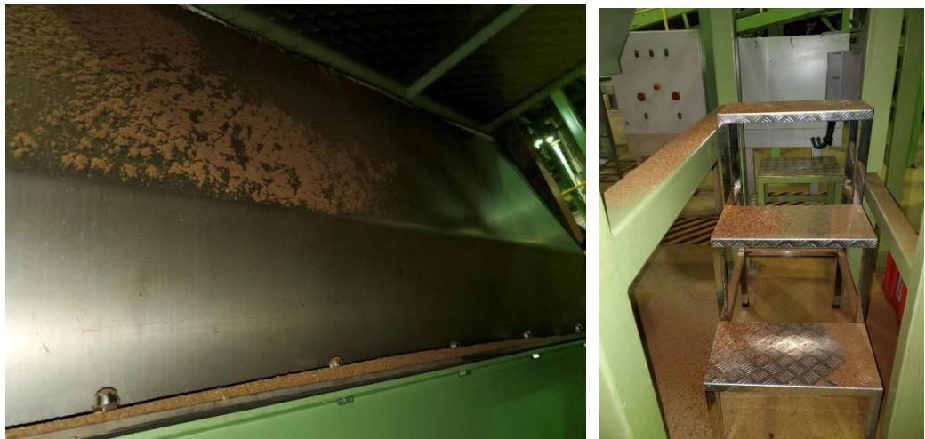
改进后：将裙边上部利用压条安装在槽体底部，消除裙边与槽体之间的间隙，提高密封效果。
